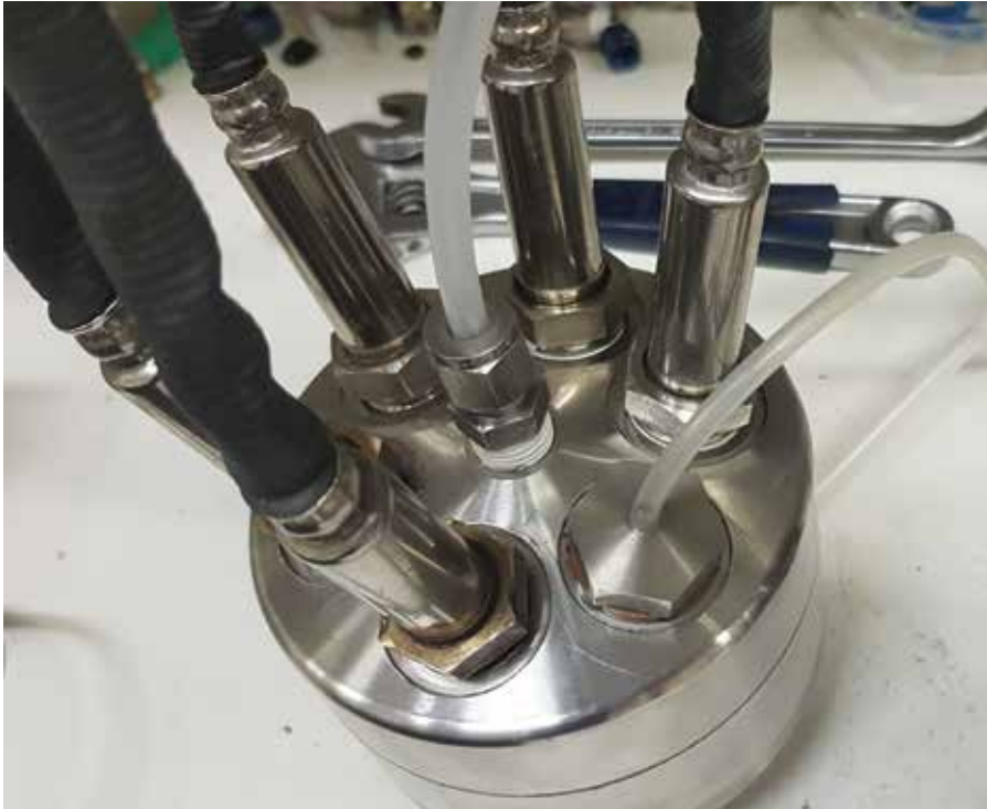
De kalibratieopstelling voor de \text{NO}_x sensoren waarin kalibratiegassen worden toegevoerd aan de meetkamer waarin meerdere sensoren zijn geplaatst.
